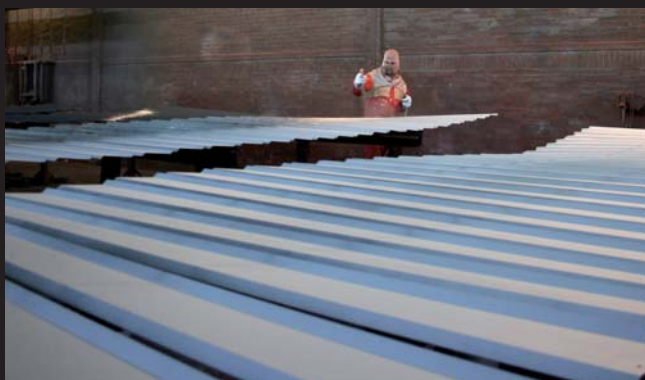
▲ De verzinkte lamellen worden in de spuitcabine gespoten.
